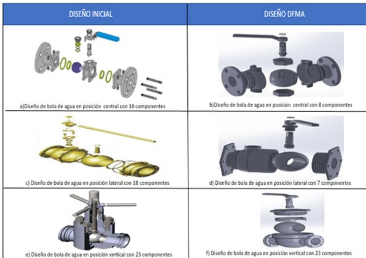
Figura 9. Diseño Inicial y Diseño DFMA para la bola de agua de la bomba hidráulica
