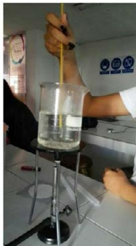
Ilustración 5. Midiendo temperatura del agua
