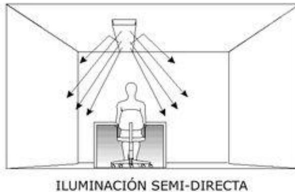
Ilustración 29. Instalación para iluminación semi-directa con alumbrado para lámparas fluorescentes.
