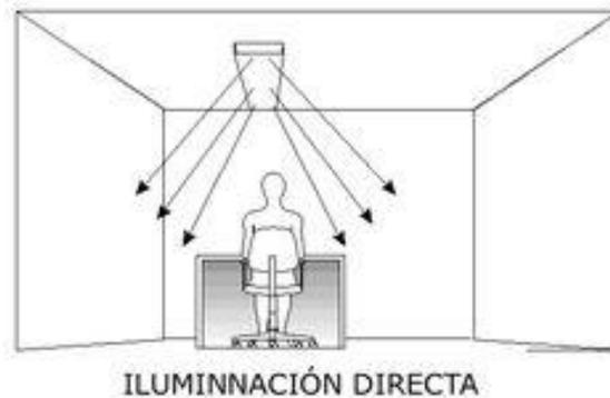
Ilustración 28. Instalación para iluminación directa con alumbrado para lámparas fluorescentes.
