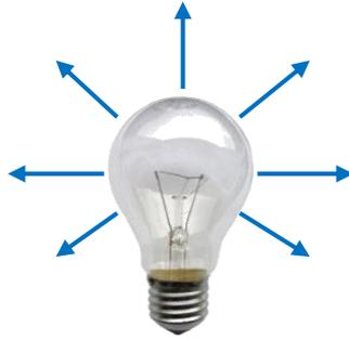
**Ilustración 15. El flujo luminoso es un índice representativo de la potencia luminosa de una fuente de luz.**
