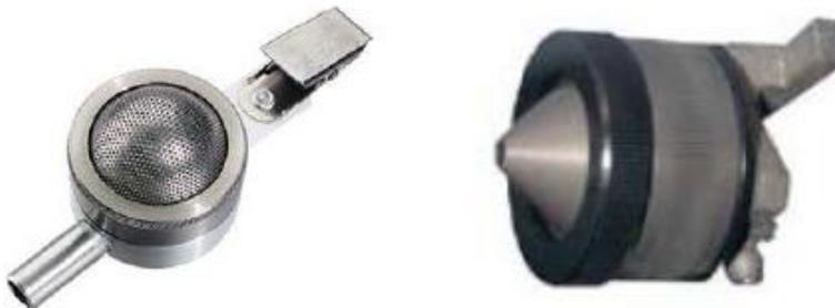
Ilustración 53. Equipo de Muestreo Button y GSP 3,5
